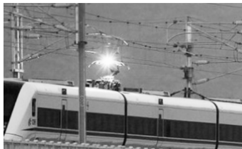
图 2. 受电弓拉弧现象
